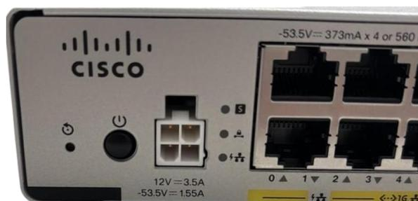
**1** : Vérifier que l'alimentation est bien branchée (prise électrique + port d'alimentation du routeur)
