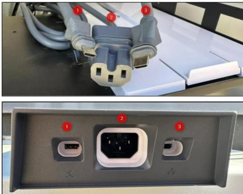
1. Connectez le câble Starlink provenant de l'antenne sur le port marqué 1 (icône d'antenne sous le connecteur).
