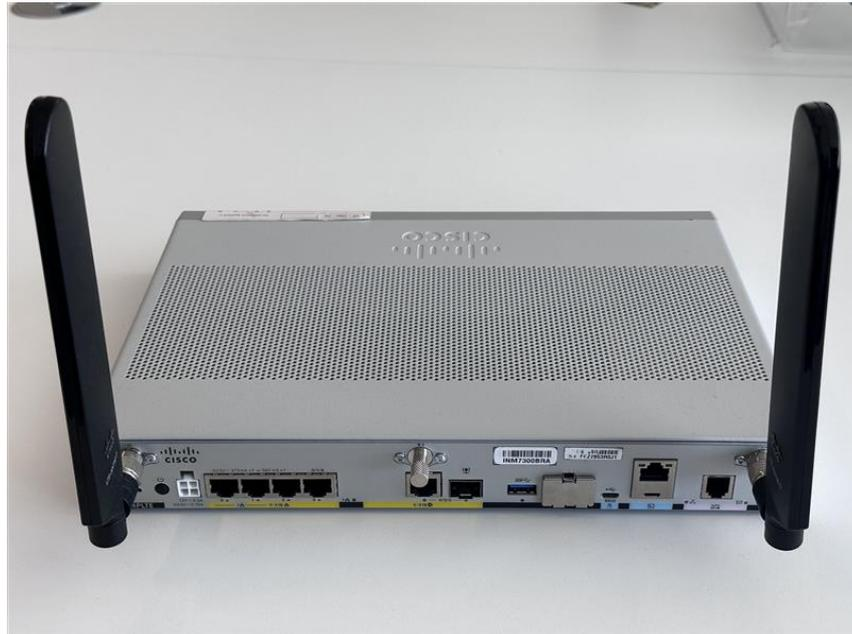
Les slots de sim se trouvent à l'arrière du routeur protégés par le cache métallique (voir photo ci dessous)
