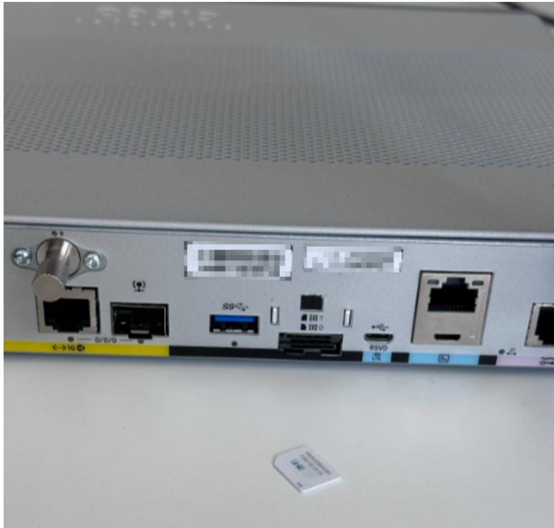
Ensuite, installer la nouvelle sim au format microsim sur le même slot que l'ancienne SIM (slot 0 - en bas).
